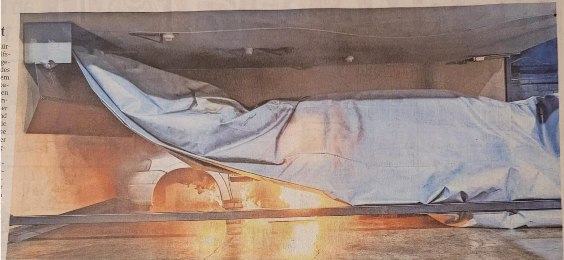
Bei einem Autobrand wird die Feuerschutzdecke automatisch aus ihrer Kassette an der Wand gezogen und über das Fahrzeug gelegt.
